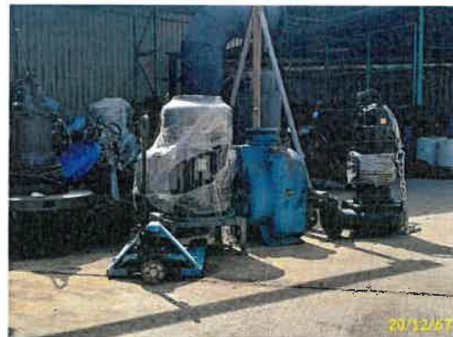
ภาพที่ 2.2-23 เครื่องสูบน้ำสำรอง
